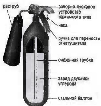
**Принцип действия** основан на вытеснении двуокиси углерода избыточным давлением собственных паров. При открывании пускового устройства углекислый газ по сифонной трубке поступает к раструбу. CO из сжиженного состояния переходит в газообразное. Углекислота, попадая на горящее вещество, изолирует его от воздуха.
